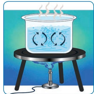
Na figura, as setas para cima representam o fluxo de água quente que sobe, enquanto as setas para baixo representam o de água fria, que desce para ser aquecido. Esse mesmo fluxo é percebido no interior das caixas de acondicionamento dos imunobiológicos, que, ao trocar calor, mantêm o ar mais quente na parte superior (abaixo da tampa). Uma das formas de evitar essas trocas de calor é manter as bobinas na parte inferior das caixas, para conservar o ar frio sempre no fundo da caixa.
